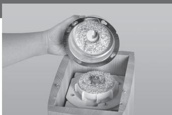
Metallmahlkammer durch Rechtsdrehung abheben und die Steine mit einer Bürste reinigen.
