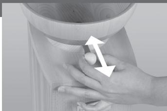
Metallschieber öffnen – Getreide fällt durch
