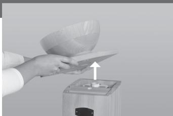
Heben Sie die Trichterplatte nach oben, um an die Steine zu gelangen.
